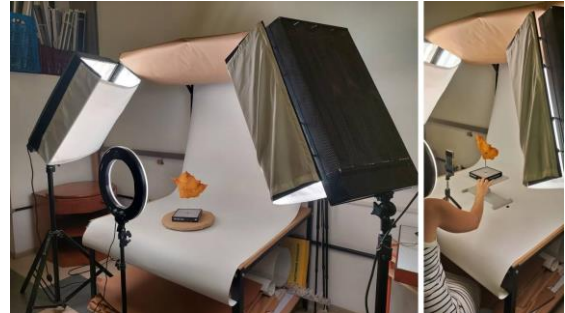
Figura 3 - Configuração definida para o processo de DT por fotogrametria. Fonte: Os autores
