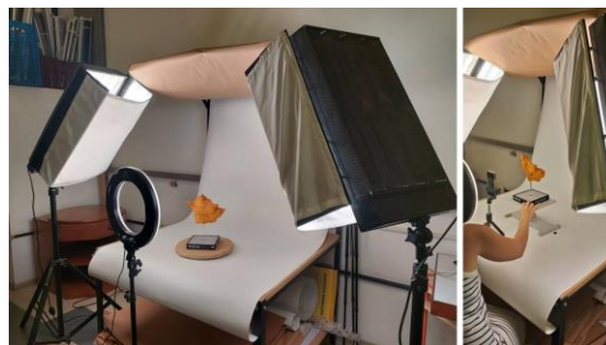
Figura 3 - Configuração definida para o processo de DT por fotogrametria. Fonte: Os autores
