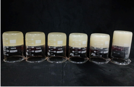
Figura 4: Amostras com 1%, 1,5%, 2,5%, 5%, 10% e 15% de concentração de monoestearato de glicerila, respectivamente.
