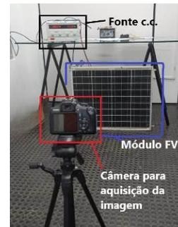
Fig. 5: Ensaio de Eletroluminescência.
