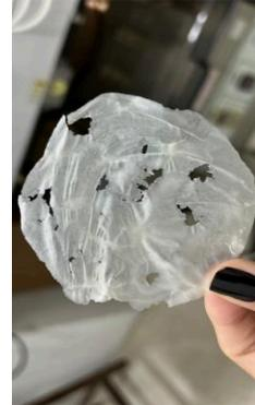
**Figura 2:** Polpa de MFC após secagem.
