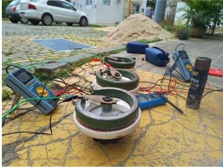
Fig. 1: Circuito utilizado para medição da curva I-V.
