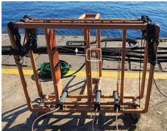
**Figura 1 - Estrutura de aeração no início do experimento in situ.**
