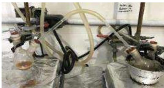
**Figura 1.** Produção de  $\text{NH}_3(\text{g})$  para obtenção do derivado de ebselen **4**.
