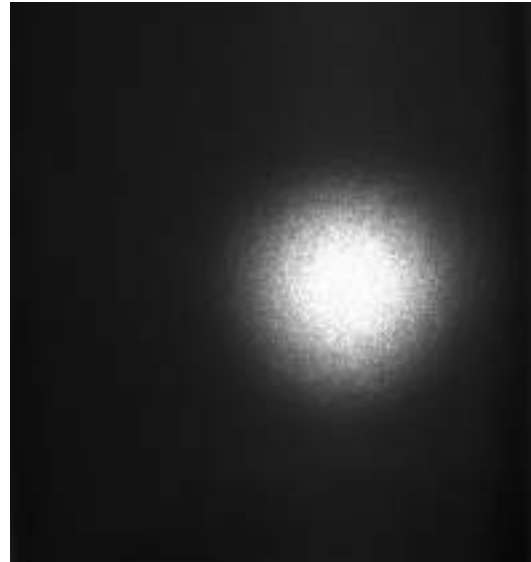
Figura 2 - Perfil de intensidade de um laser transmitido por uma cavidade óptica.
