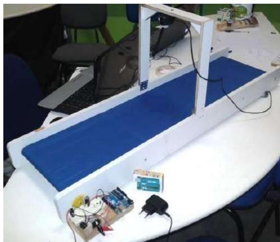
Figura 2 – Sistema de inspeção: esteira, câmera e computador.
