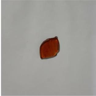
Figura 1: Vidro sinterizado com adição de escória.
