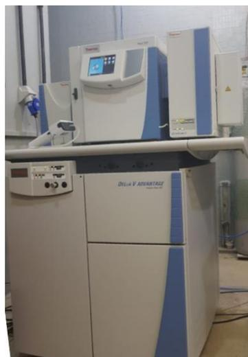
**Figura 2.** Equipamento de GC-C-MS-IRMS presente no laboratório LARA
