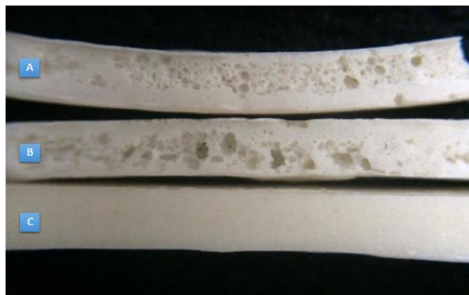
Foto 1. Em “A” e “B” 50% de pó de concha em peso - tempo de compressão de 30min. “C” 10% de pó de concha em peso - tempo de compressão de 6 horas.
