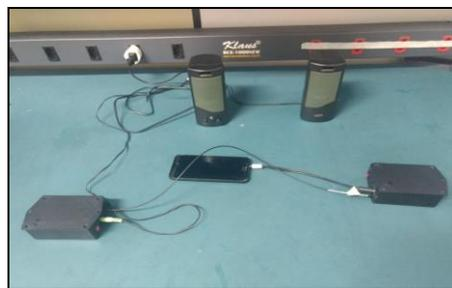
Fig. 12. Fotografia do enlace óptico de áudio com POF, completo.
