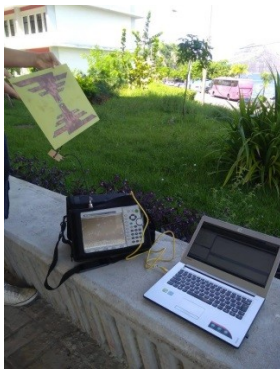
Fig. 3 –Medição do protótipo da antena DTV fabricada no LAPROP realizada no IC do campus da Praia Vermelha da UFF , posicionada na direção da Baía de Guanabara (Sumaré - RJ)
