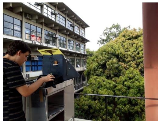
Fig. 2 –Medição do protótipo da antena DTV fabricada no LAPROP realizada entre os blocos D e E da escola de Engenharia.
