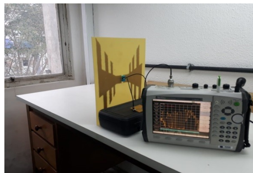
Fig. 1 – Análises da caracterização experimental do protótipo da antena DTV fabricada no LAPROP realizada dentro do laboratório.
