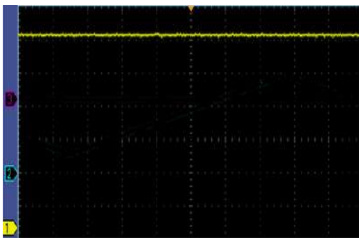
Figura 8: Intensidade do feixe transmitido pelo OPO estabilizado.
