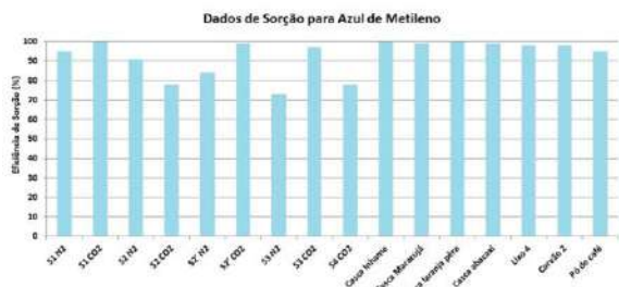
Figura 2: Eficiência de sorção de azul de metileno pelos biocarvões
