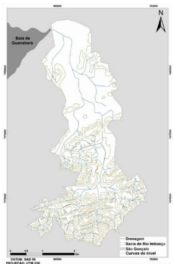
Figura 1 - Mapeamento dos canais disponíveis ao escoamento na bacia. (Elaborado pela autora, 2015).
