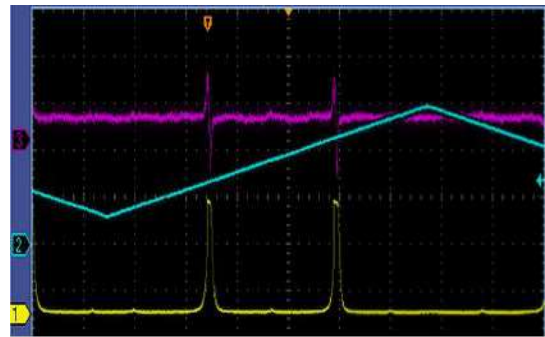
Figura 6: Picos de ressonância (Canal 1), rampa que representa o movimento do espelho (canal 2) e Sinal de erro (Canal 3).
