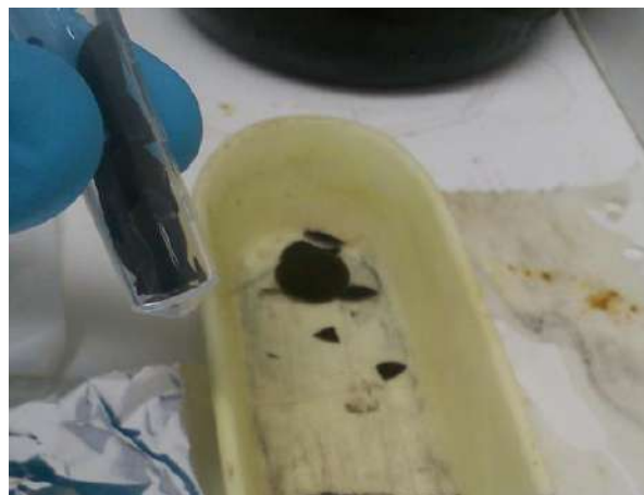
Figura 2: Retirada das membranas após a retirada do forno
