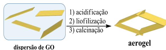
Figura 1: Esquema da síntese do aerogel de GO.
