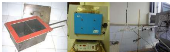
Figura 1: Conversão de biomassa em biocarvão a baixa temperatura.
