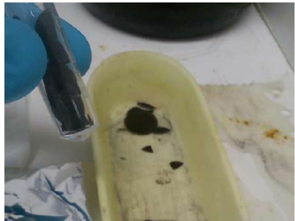
Figura 2: Retirada das membranas após a retirada do forno
