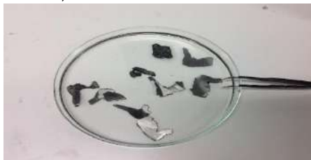
Figure 1: Gadolínio cortado em partes para ser laminado em "filetes" de (0,5x0,2)cm.
