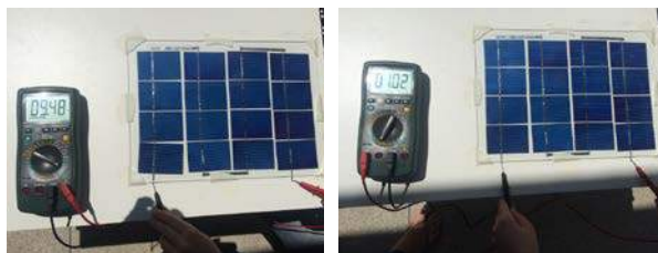
Figura 2 – Testes com a placa fotovoltaica: tensão de circuito aberto (à esquerda) e corrente de curto-circuito (à direita).
