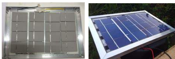
Figura 3 – Placa fotovoltaica finalizada.
