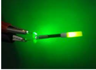
Figura 1 - Fonte fluorescente com LED verde (520 nm) e fibra dopada emitindo no amarelo (560 nm).
