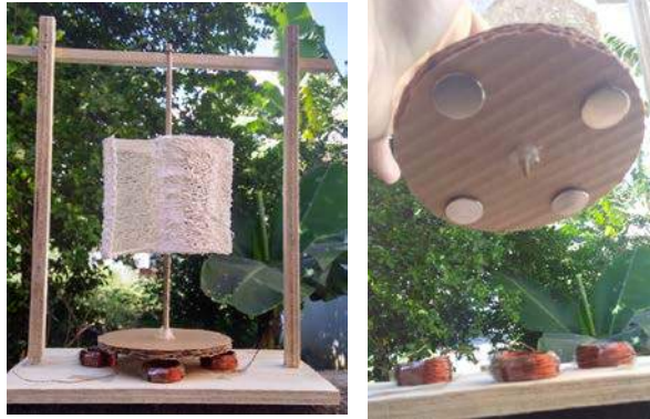
Figura 8 – Turbina 3D do tipo Savonius e gerador de ímã permanente.
