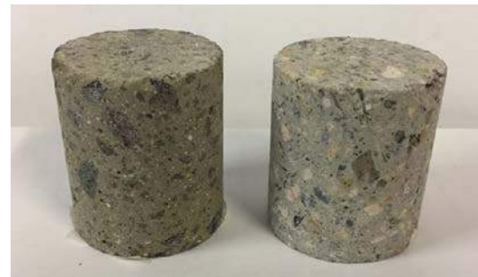
Figura 1: Concreto refratário sem reforço (esquerda) e com reforço (direita).
