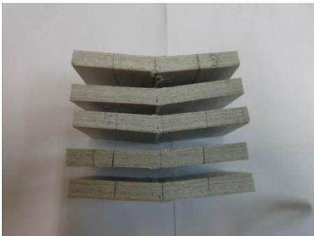
Figura 9 – Modo de ruptura dos corpos de prova ao cisalhamento transversal das fibras.
