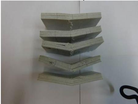
Figura 8 – Modo de ruptura dos corpos de prova ao cisalhamento longitudinal das fibras.
