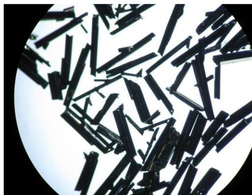
Figura 1. Cristais de  $\text{Co}_5\text{Ti}(\text{O}_2\text{BO}_3)_2$  em forma de agulhas
