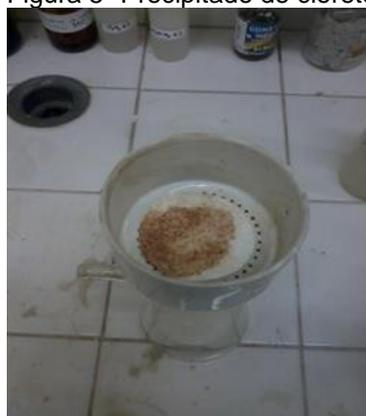
Figura 6- Precipitado de hidróxido de ferro
