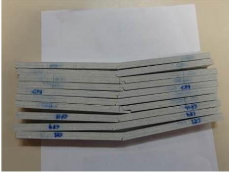
Figura 8 – Modo de ruptura dos corpos de prova à flexão simples.
