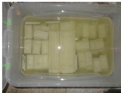
Figura 2 - Os corpos de prova dispostos no recipiente contendo solução alcalina.
