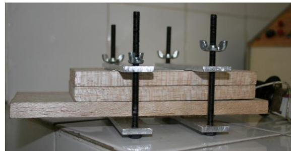
**Figura 2.** Protótipo do Medidor Caseiro de Condutividade Térmica.
