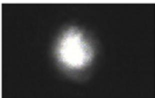
Figura[1]: Perfil de intensidade de um feixe (modo gaussiano ou fundamental) obtida com uma câmera CCD no Laboratório de Ótica Quântica (LOQ).
