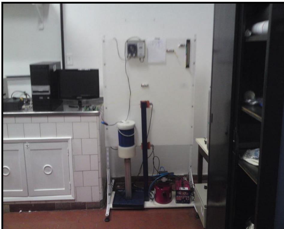
Figura 1: Sistema de especiação de mercúrio montado no laboratório
