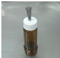
**Figura 1:** Minirreator utilizado para a reação de transesterificação dos ésteres lipídicos
