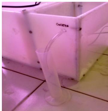
Figura 2: Saída da água sem sedimentos
