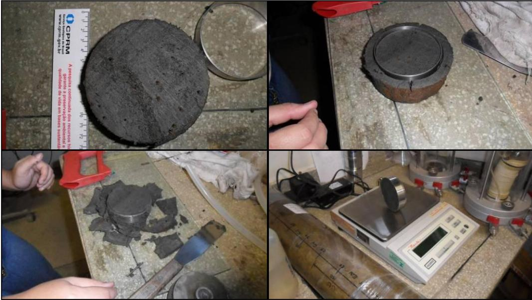
**Figura 1** – Detalhe da preparação e pesagem inicial do corpo de prova moldado em argila mole.
