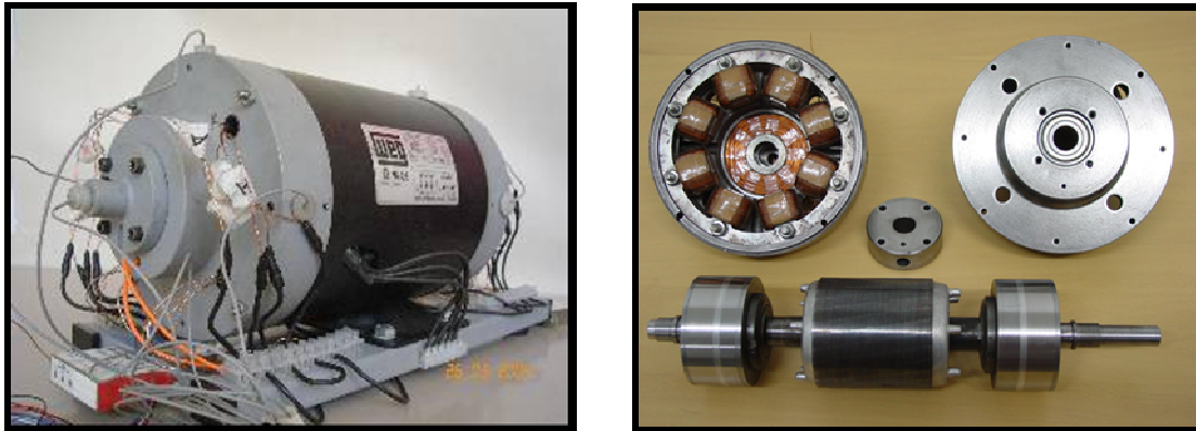
Figura 1. (a) Protótipo de motor de indução com mancais magnéticos, (b) rotores do motor e dos MMs e os estatores dos MMs.
