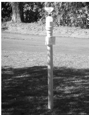
Figura 1. Esquema ilustrativo do coletor de deposição total (DT)
