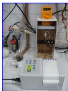
Figura 1. Sistema simplificado desenvolvido para acompanhamento da turbidez de solução.
