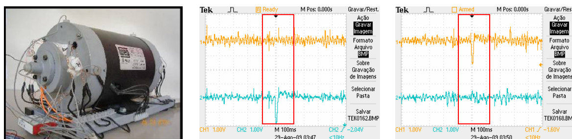
Figura 1. (a) Motor elétrico de indução com mancais magnéticos radiais (b) \omega_s = 60 Hz e n = 3.530 rpm (perturbação vertical na tampa direita). 0.1mm/div. (c) \omega_s = 60 Hz e n = 3.530 rpm (perturbação horizontal na tampa direita). 0.1mm/div.
